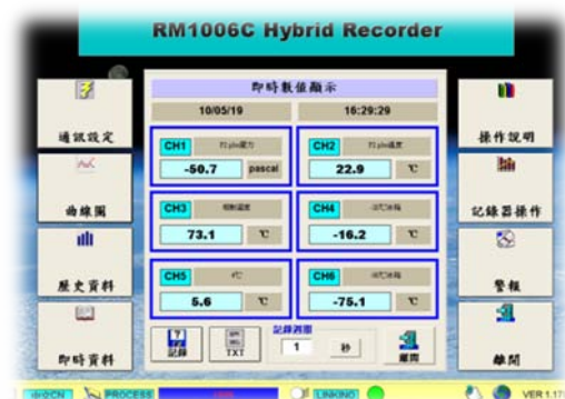
數值記錄器分別記錄實驗室溫度、實驗室壓力、實驗室濕度、-80°C 冷凍櫃、-20°C 冷凍櫃、4°C 冷藏櫃
